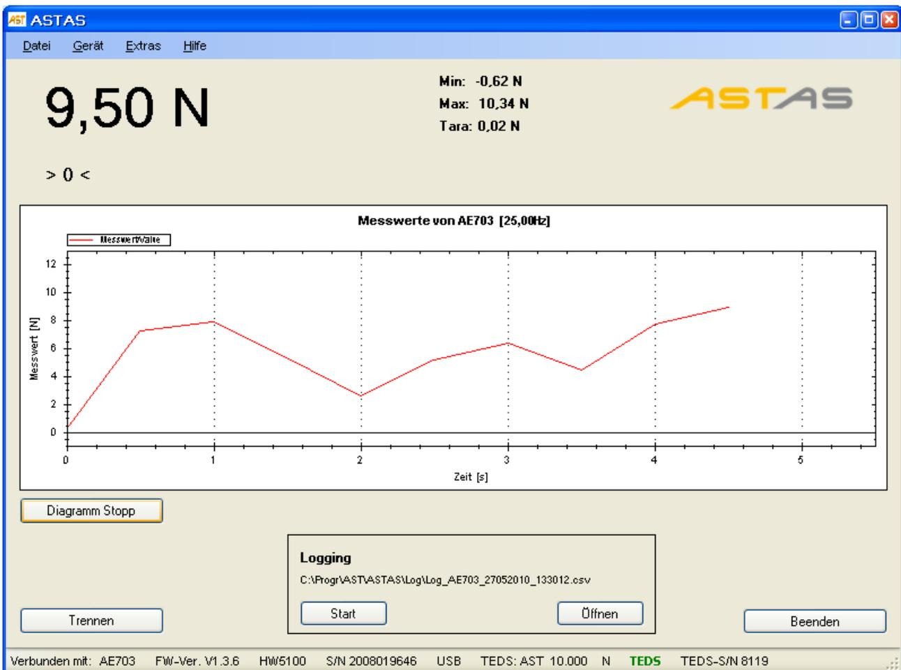
Die Software sucht automatisch passende USB-Geräte und verbindet automatisch, sofern nur ein Gerät angeschlossen ist. Angezeigt werden Kraft, Minimalwert, Maximalwert, verwendetes Gerät, Tara, Überlast, Kraft-Zeit-Diagramm, Logdateiname und Loggen aktiv.
