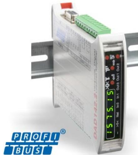
Der DMS-Messverstärker mit digitaler Anzeige zur Normschienenmontage eignet sich besonders für die Wandlung von DMS-Signalen in Profibus DP-Signale. Diese können somit leicht in eine SPS eingespeist werden. Zusätzlich gibt es eine 6-stellige Anzeige und vier Tasten für die wichtigsten Funktionen. Acht LEDs zeigen Statusinformationen an. Zwei optisch isolierte Eingänge: und zwei Relaisausgänge erlauben eine digitale Kommunikation mit der Maschine.
