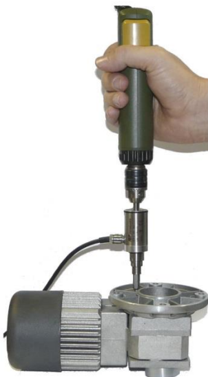
Foto: Drehmomentmessung mit Schrauber
