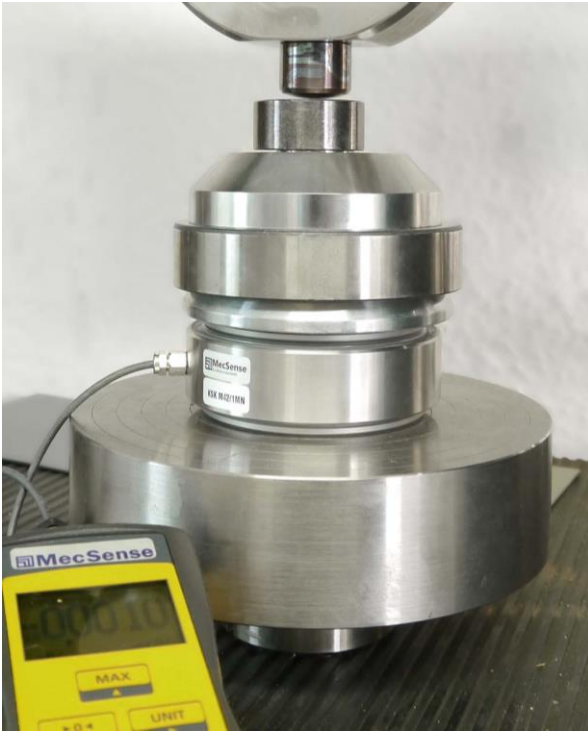
Foto: Kraftmessring KSK beim Kalibrieren
