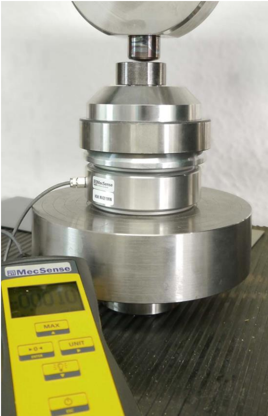
Foto: Kraftmessring KSK beim Kalibrieren
