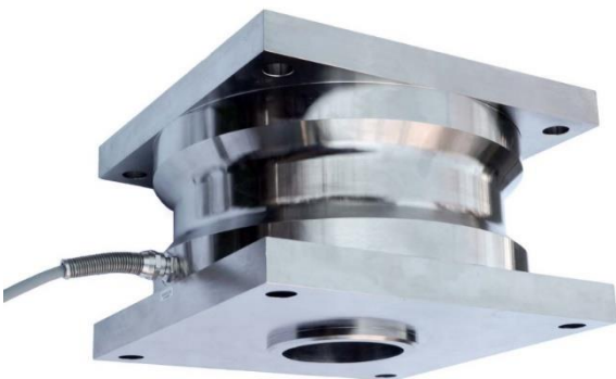
Foto: kundenspezifischer Kraftmessring (Rohrtyp) für eine Servopresse. Er arbeitet in Druckrichtung bis 150 kN und in Zugrichtung bis 50kN
